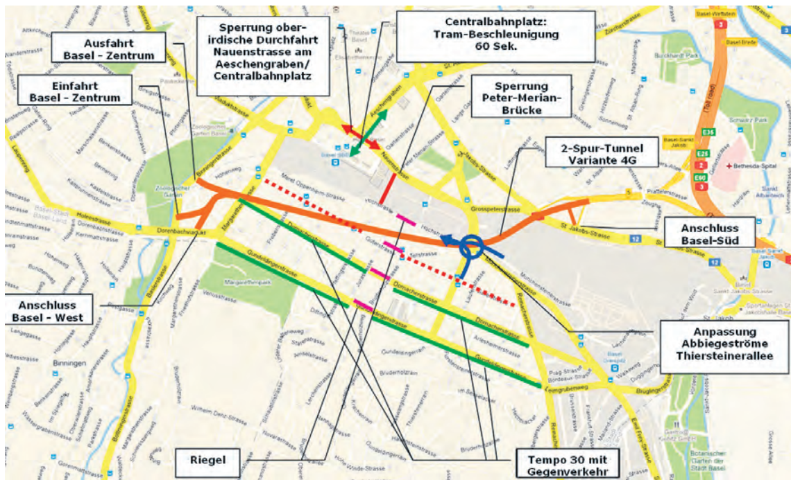
«A2 - Abschnitt 7/Schemenskizze alle Massnahmen» - Auf dieser Skizze wird die geplante Untertunnelung der neuen Verkehrsachse unter dem SBB-Areal und Gundeli (Orange markiert) dargestellt. Zur besseren Verständlichkeit bezeichnen wir das Bauprojekt als «Gundelitunnel». Erkennbar sind auch die mit dem Tunnelbau verbundenen anderen Verkehrsmassnahmen in dessen Umfeld. Skizze: Bau-Dep. BS
