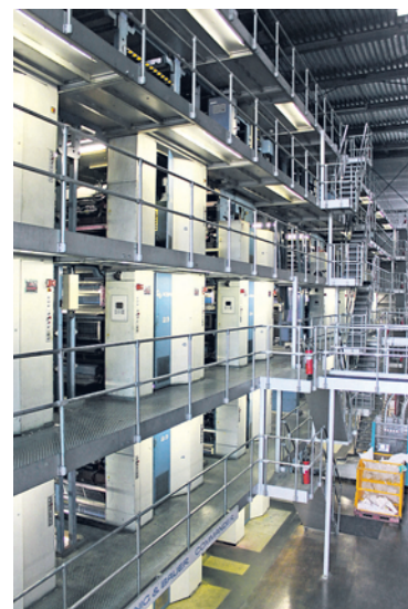
Die riesige Commander KBA (König&Bauer) Druck-Maschine (Jahrgang 2004) der «BaZ»-Druckerei (Die Zeitungsdrucker Schweiz AG) wurde verkauft (an wen durften wir nicht erfahren) und sie wird in den kommenden Tagen abgerissen... Foto: GZ.
