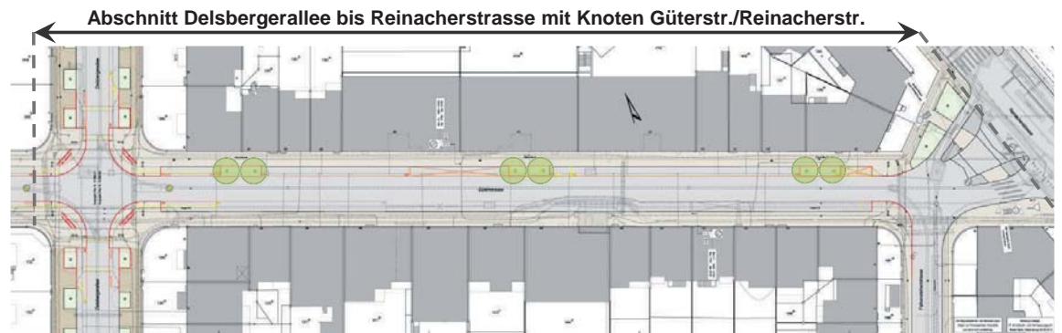
Neue Baumstandorte Abschnitt Delsbergerallee bis Reinacherstrasse.
