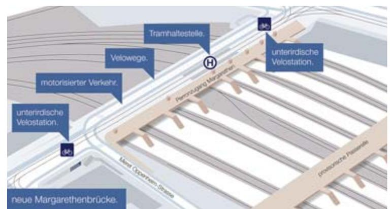
Die neue Margarethenbrücke: Die Brücke wird breiter, verfügt neu über eine barrierefreie Tramhaltestelle sowie eine sichere und komfortable Veloquerung.
